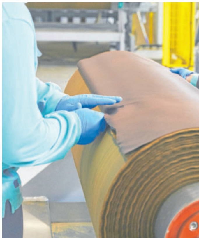
JAKO LINO. Kotouč tabákové hmoty používaný v náplních pro zařízení IQOS vyráběný v italské Boloni. Foto: PMI
